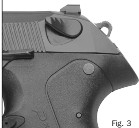
cane disarmato-sicura disinserita
