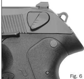
cane disarmato-sicura inserita
