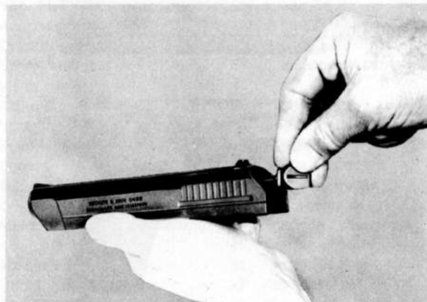
Fig. 8: Removing the firing pin Sacar el percutor Enlever le percuteur
