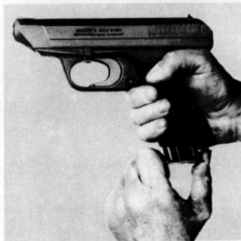
Fig. 5: Removing the magazine Quitar el cargador Enlever le chargeur
