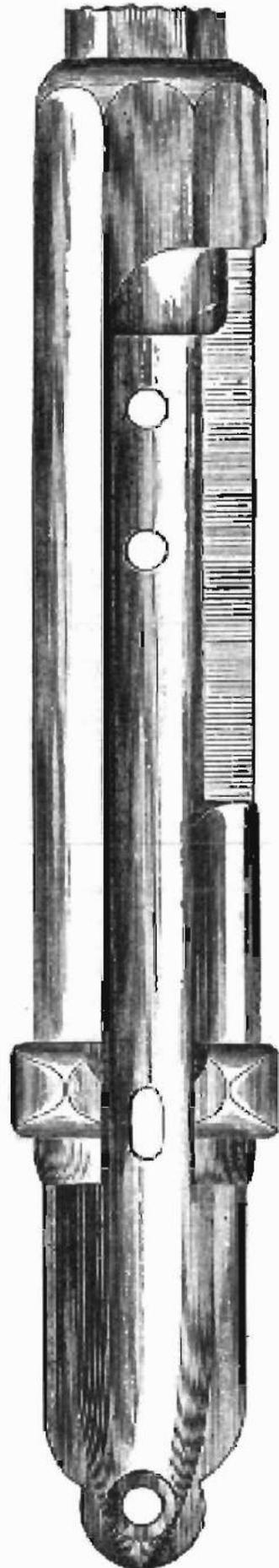
Thätigkeit, wenn man die Kammer aus der Hülse nimmt. Der untere Theil der Abzugsstange heißt die **Bunge**. In den langen Theil ist dicht vor dem gabelförmigen der nach vorn verlängerte Abzugsfederstollen mit einem **Bapfen** eingeschoben und durch einen **Stift** befestigt. Die hintere Fläche des Abzugsfederstollens setzt
