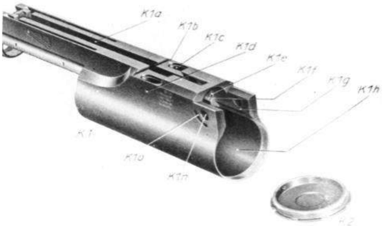
Abb. 24: ED 131, Gehäusekörper (K 1) und Deckel (K 2)
