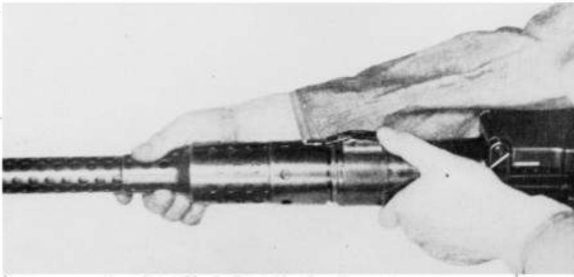
Abb. 68: Ausbau des Mantels mit Lauf
