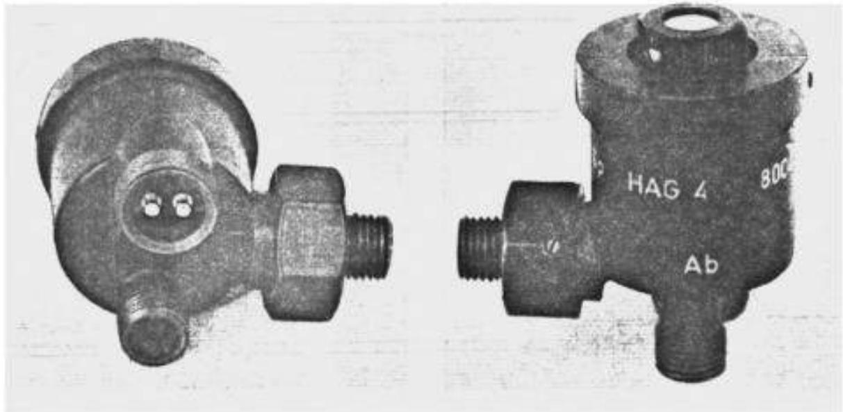
**Abb. 44: Luftspanneinrichtung (N), Hauptteil Spannkopf SpHAG 4**
