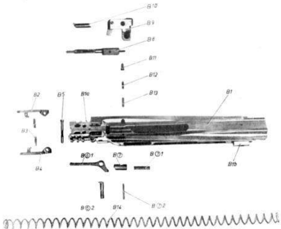
Abb. 7: Verschluß (B); Einzelteile
