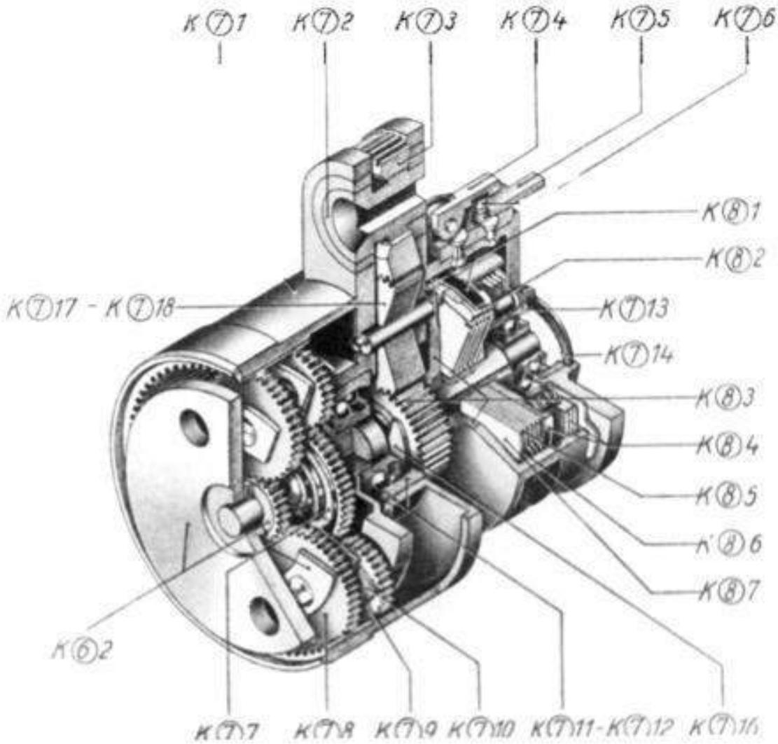
Zchnng. 29: ED 131, Getriebe (K(7)) mit Rutschkupplung (K(8)),
