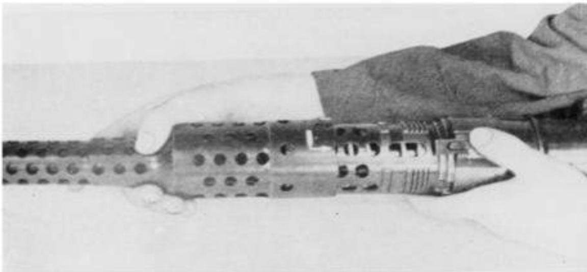
Abb. 69: Einbau des Mantels mit Lauf
