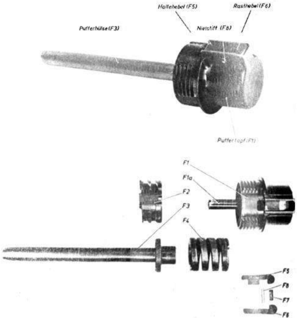
Abb. 14: Verschußpuffer (F) mit Einzelteilen
