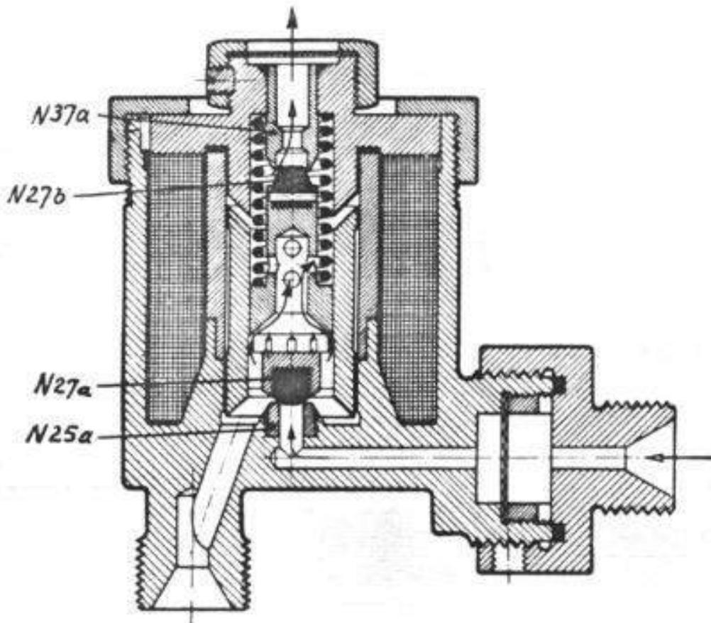
**Zchnng. 46: Spannkopf SpHAG 4 ausgeschaltet, Schnittzeichnung**
