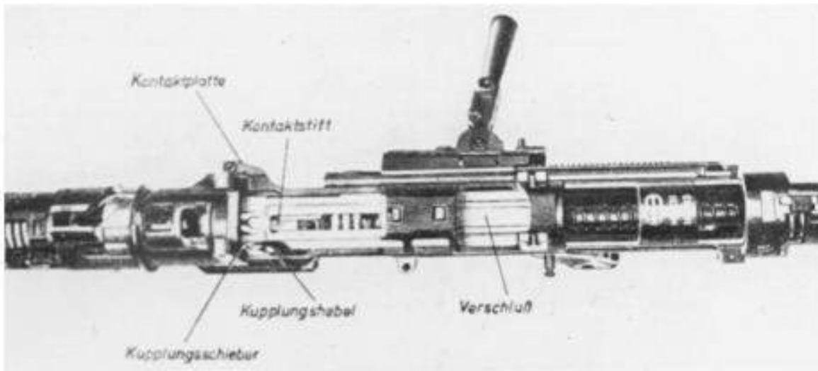
**Abb. 51: Verschluß entkuppelt (Schnittmodell), Ansicht von oben**
