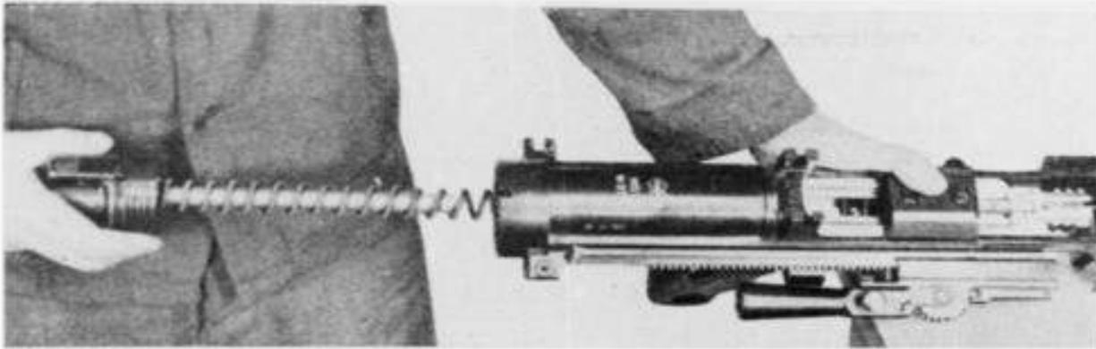
**Abb. 72: Einführen des Verschlusses**
