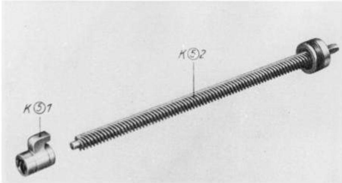
Abb. 26: ED 131, Spindel mit Lagerung (K 5)
