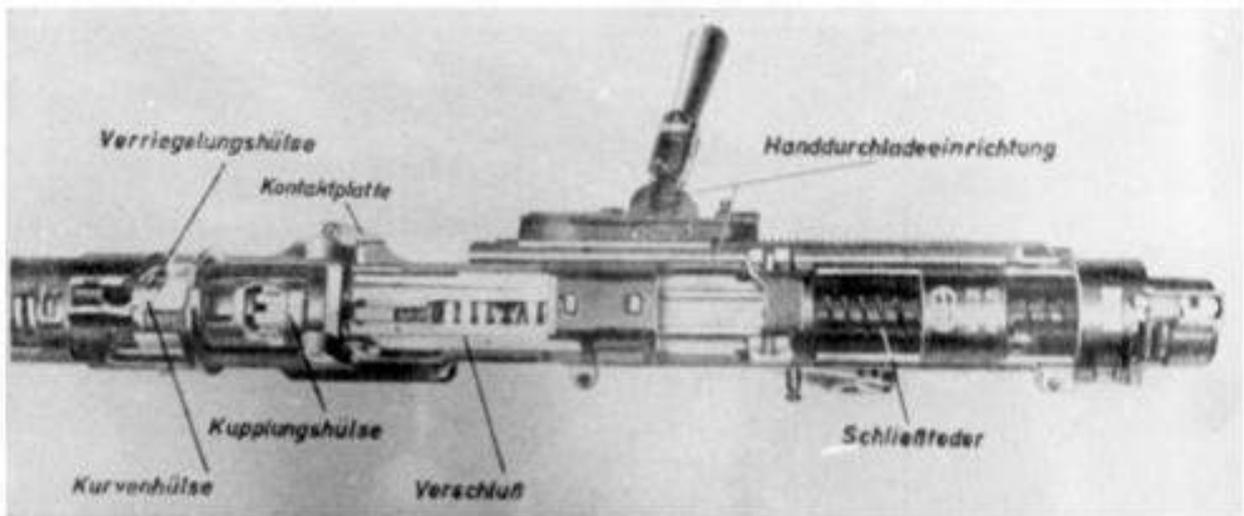
Abb. 50: Verschuß entriegelt (Schnittmodell), Ansicht von oben
