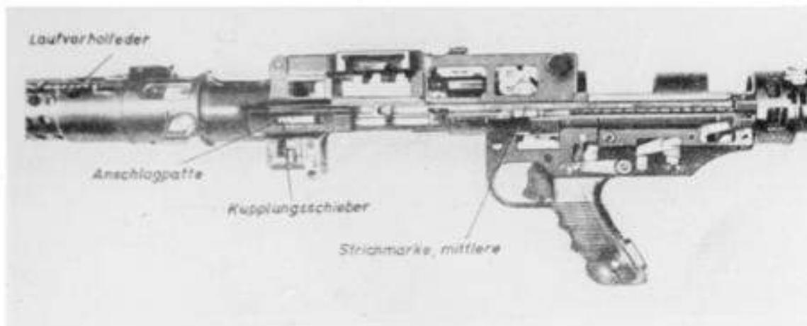
**Abb. 52: Verschluß entriegelt und entkuppelt (Schnittmodell)**
