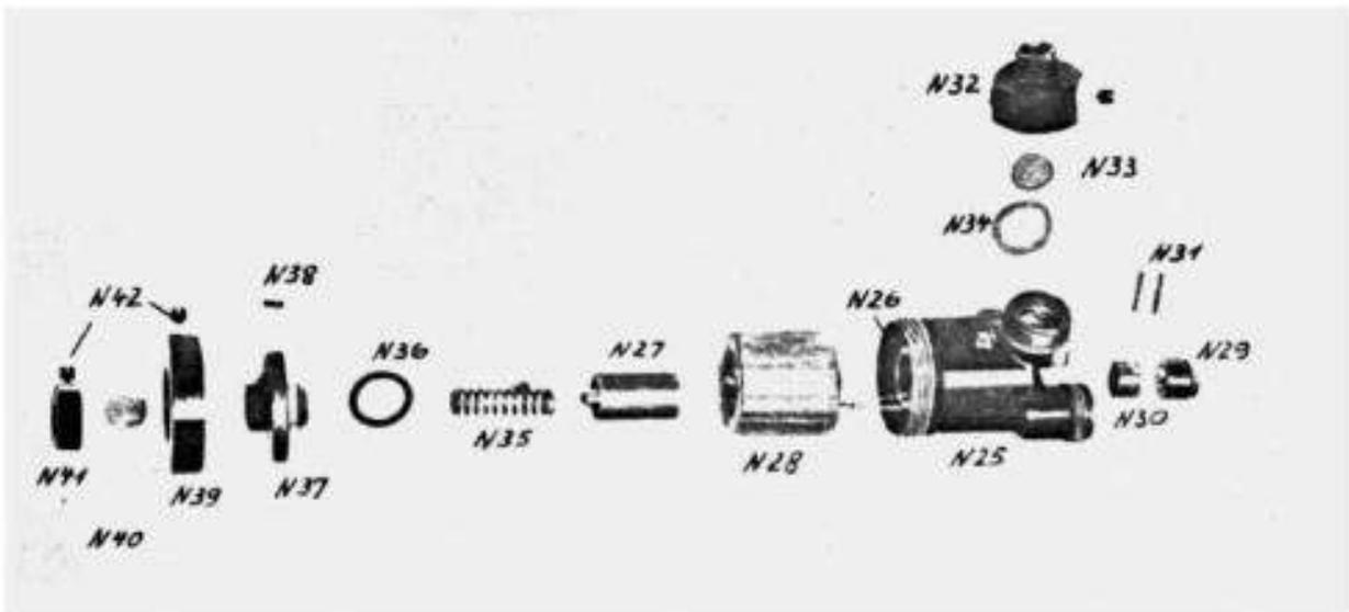
Abb. 45: Luftspanneinrichtung (N); Einzelteile
