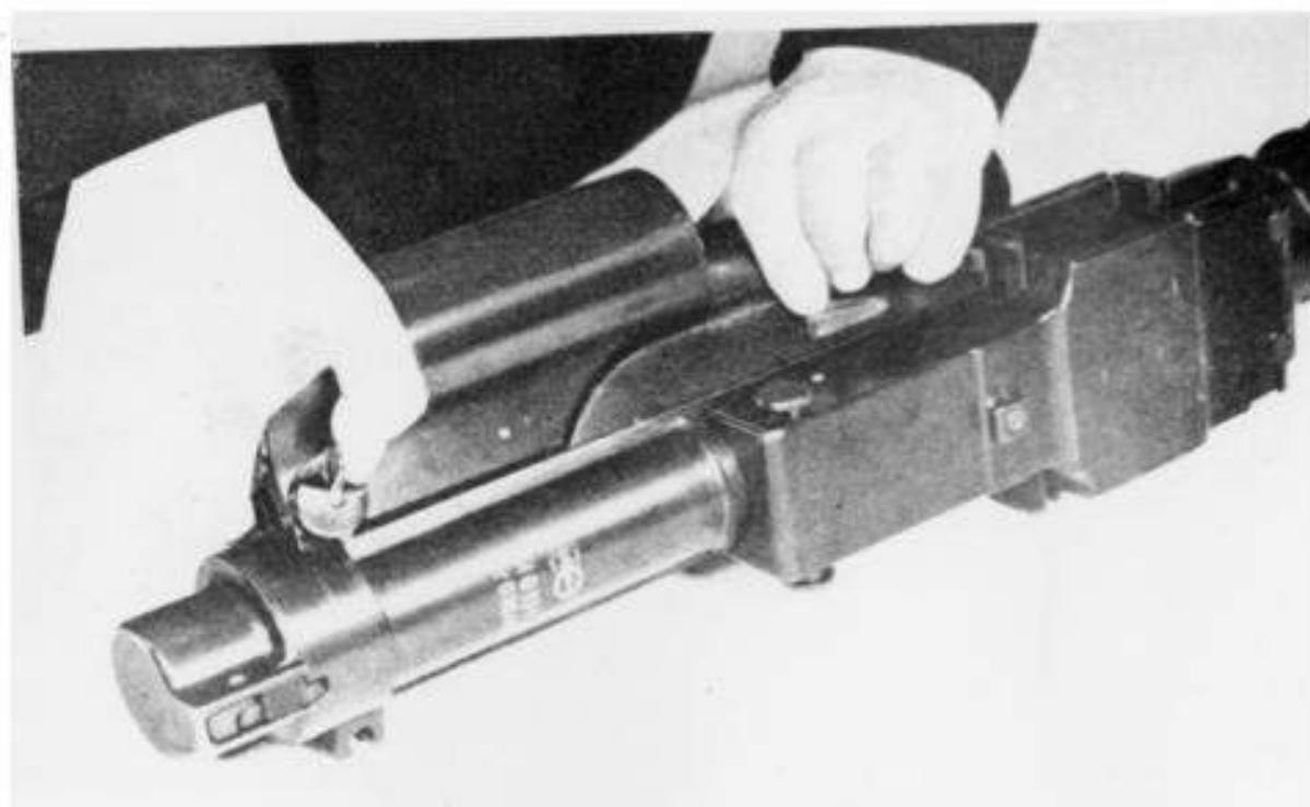
**Abb. 77: ED wird verriegelt (Linksanbau)**
