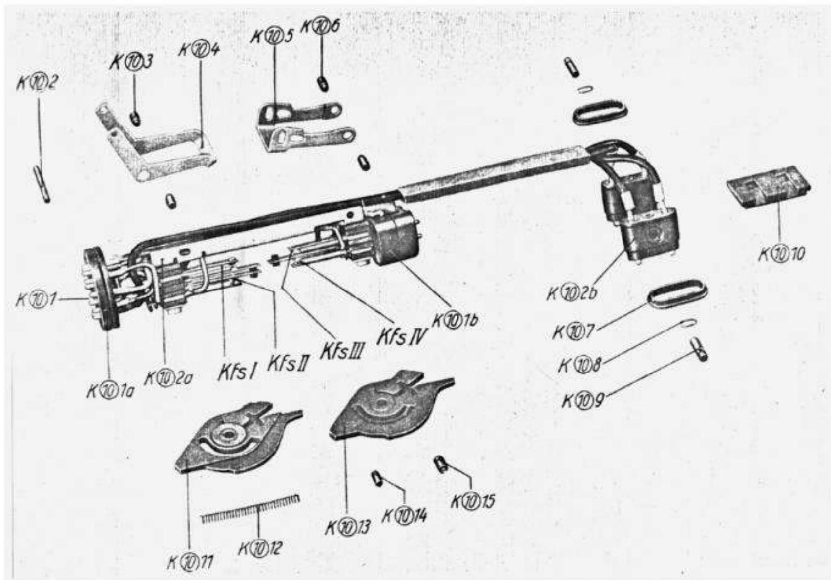
Abb. 32: ED 131, Kontakteinrichtung (K<sub>10</sub>); Einzelteile
