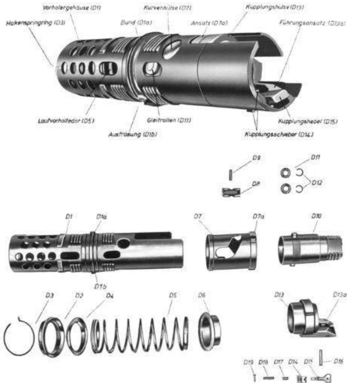
Abb. 10: Vorholer (D) mit Einzelteilen
