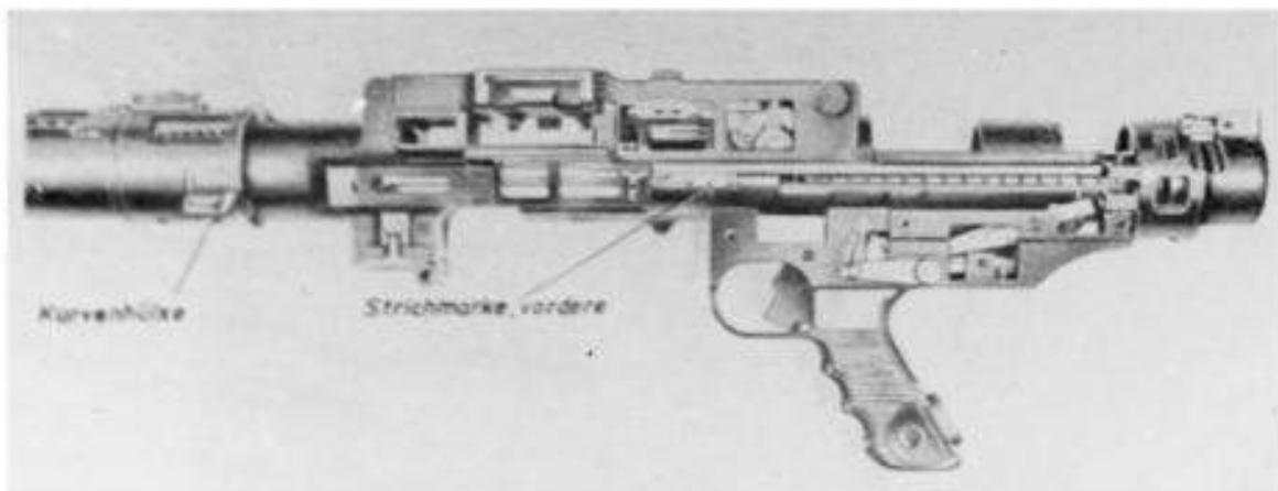
Abb. 49: Verschuß in vorderster Stellung (Schnittmodell)
