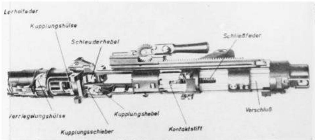
**Abb. 53: Verschluss gespannt (Schnittmodell), Ansicht von oben**
