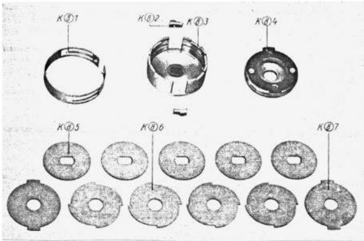
Abb. 31: ED 131, Rutschkupplung (K<sub>8</sub>); Einzelteile
