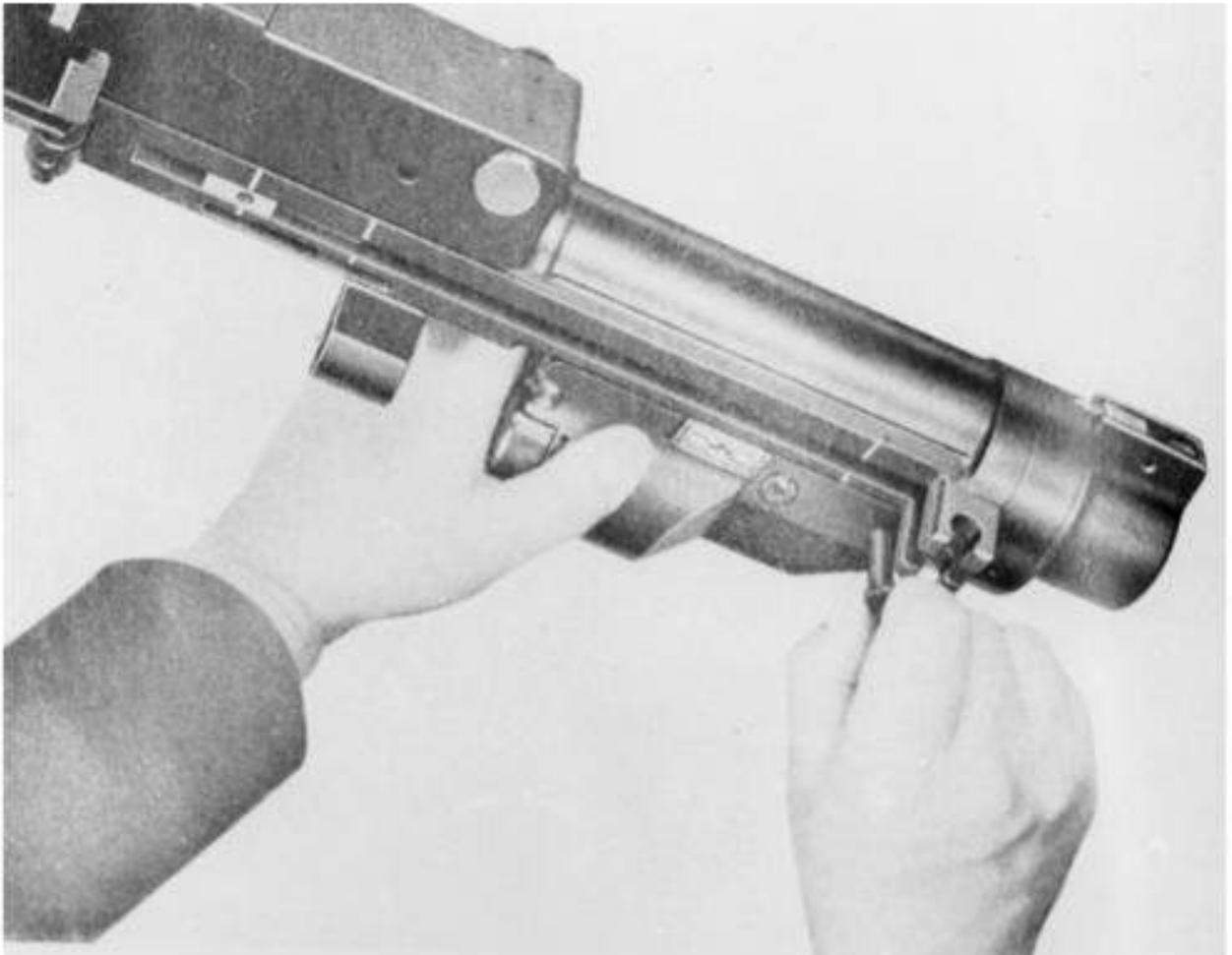
**Abb. 79: EA, Federbolzen wird eingeschoben**
