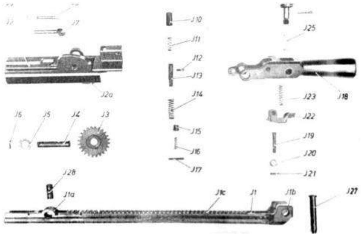
Abb. 20: Handdurchladeeinrichtung (J); Einzelteile
