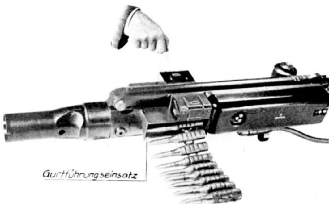
Abb. 91: Einziehen des Gurtes (Gurtzuführung von links)
