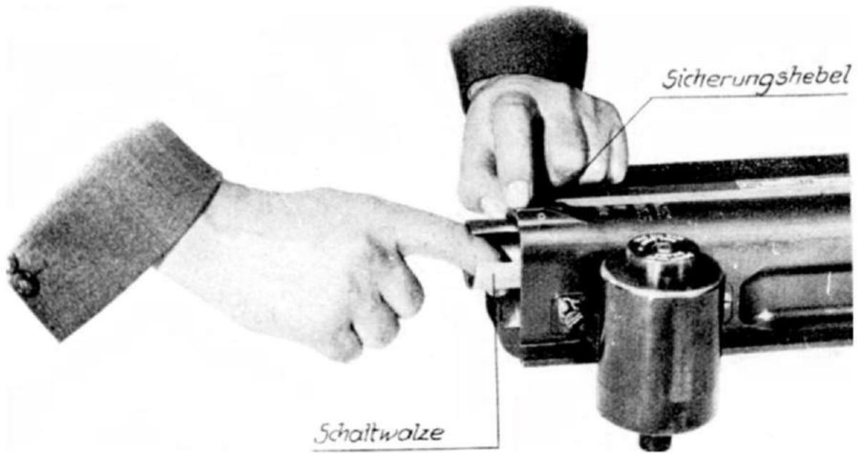
Abb. 73: Herausnehmen der Schaltwalze
