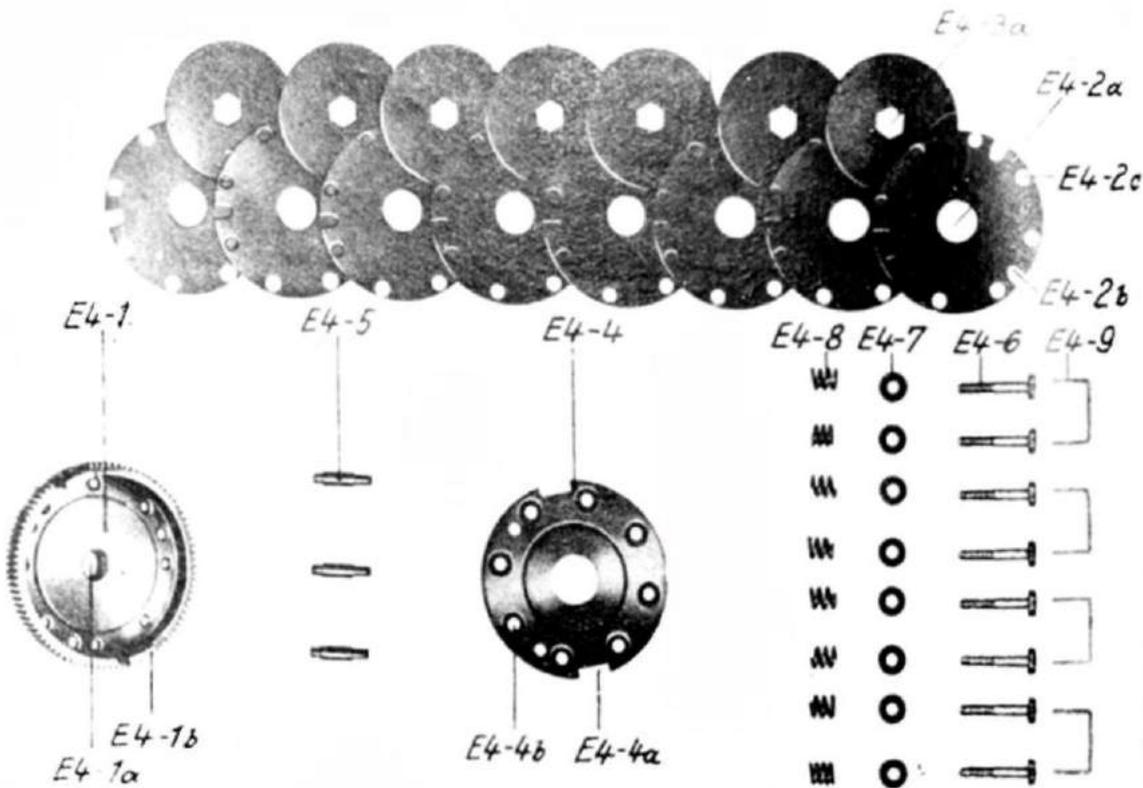
Abb. 32: ED 151 B; Rutschkupplung; Einzelteile
