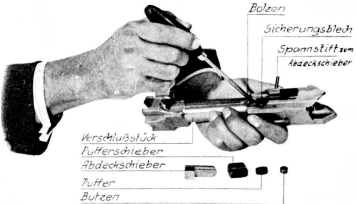
Abb. 82: Herausschieben des Sicherungsbleches
