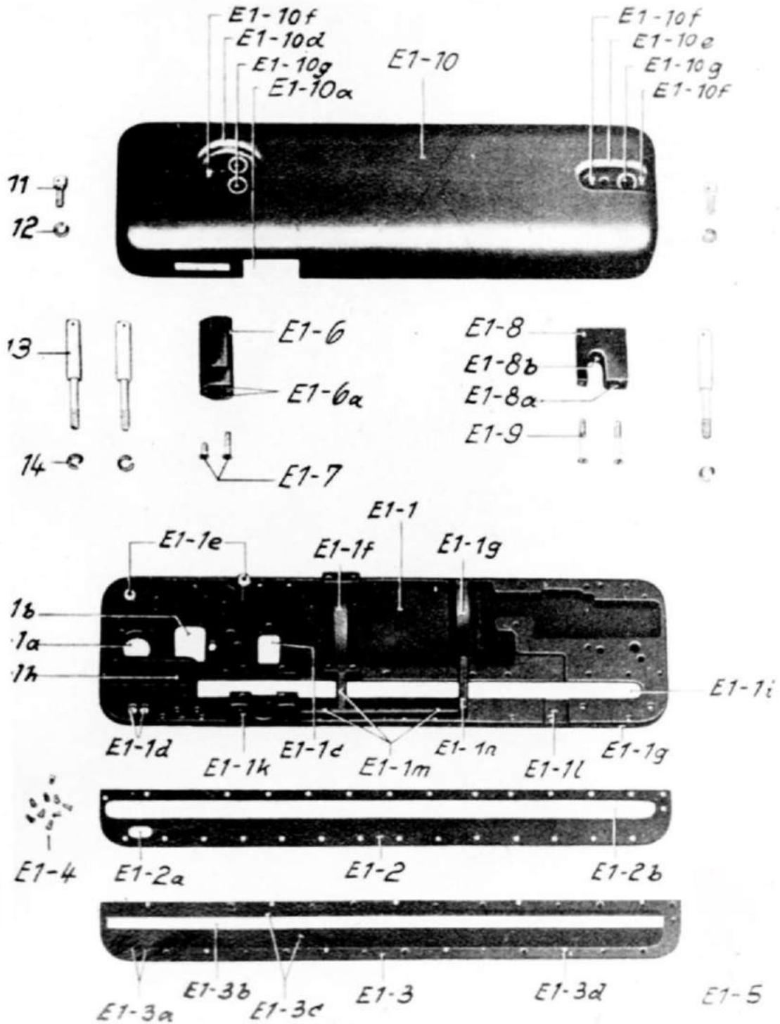
Abb. 28: ED 151 B; Gehäuse, Einzelteile
