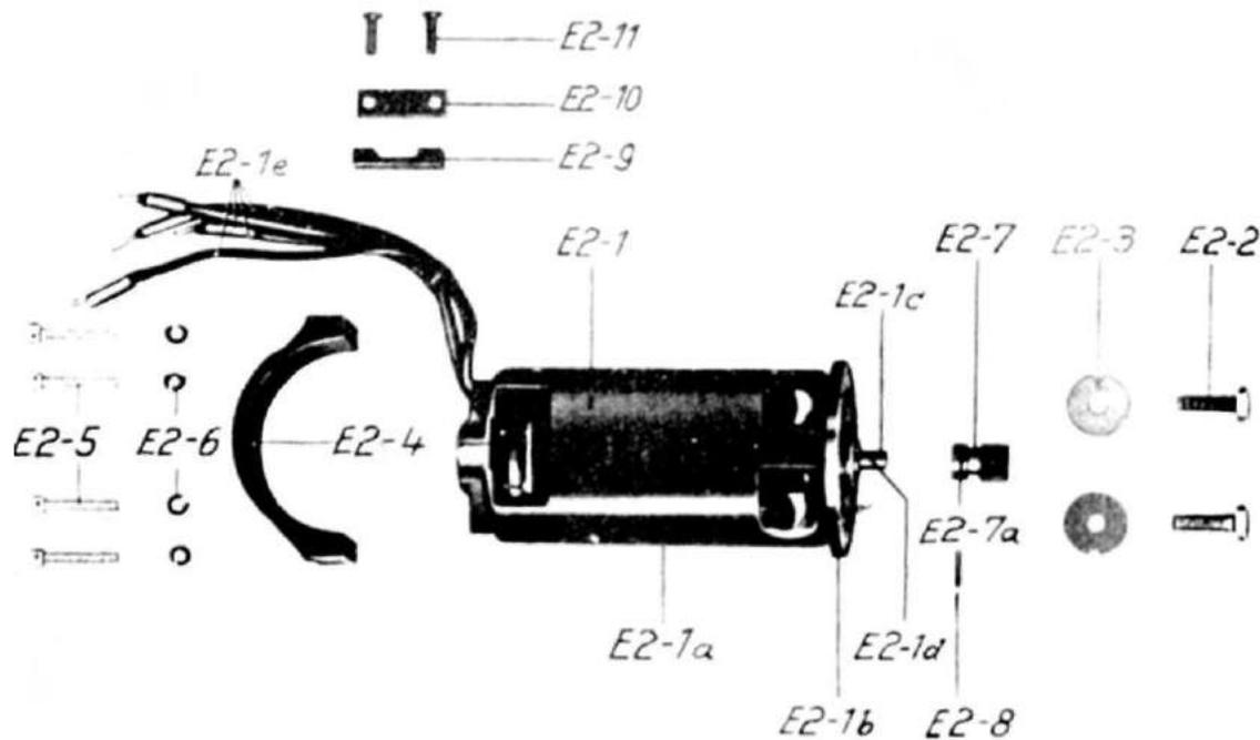
Abb. 30: ED 151 B; Antrieb; Einzelteile
