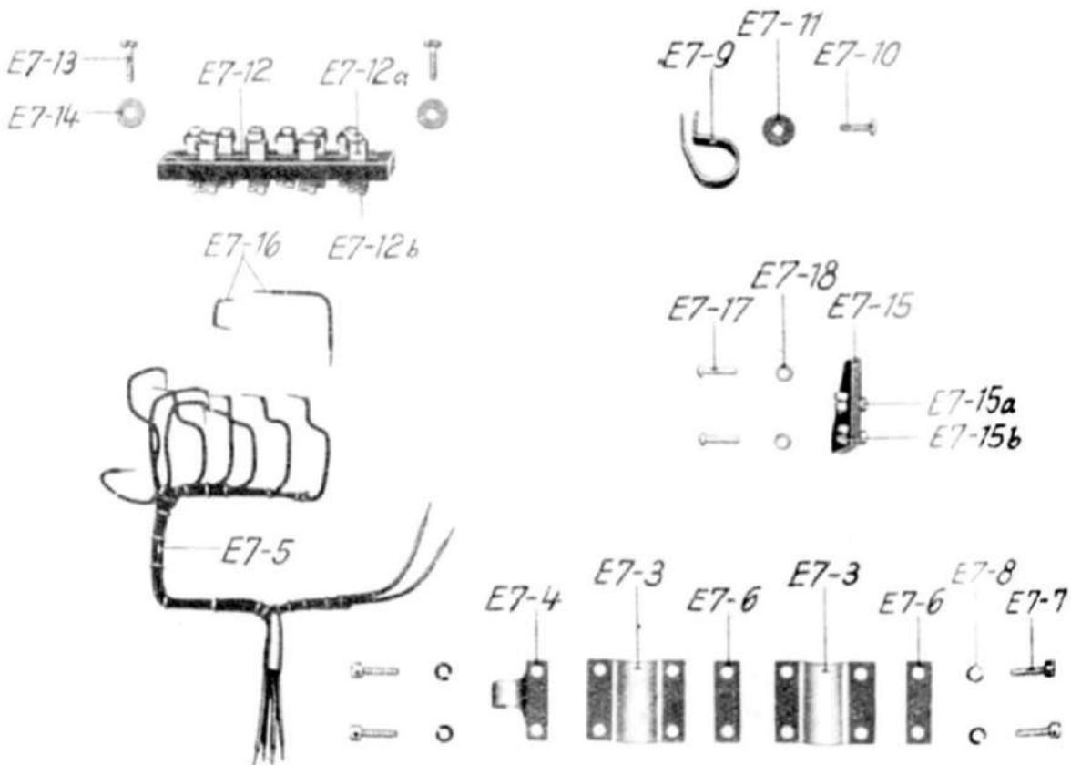
**Abb. 37: ED 151 B; Stromzuleitung; Einzelteile**
