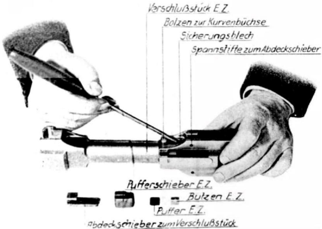
Abb. 87: Herausschieben des Sicherungsbleches (EZ)
