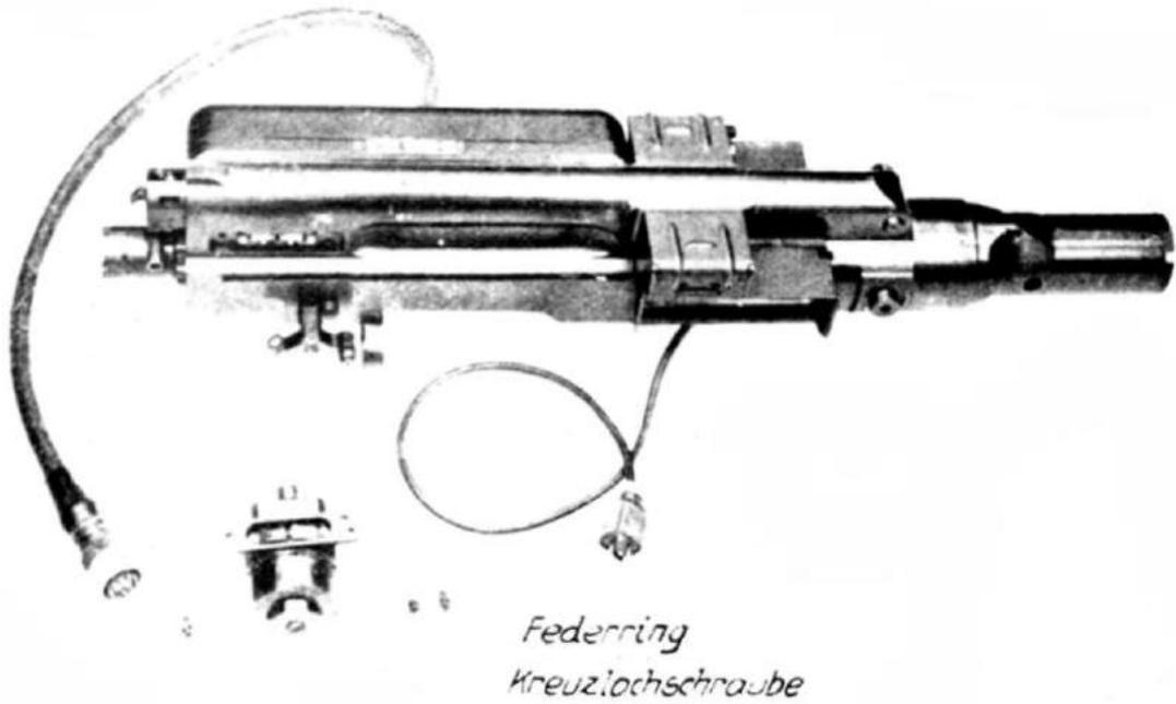
Abb. 68: Elektrische Abzugseinrichtung (EA 151/1); abgenommen
