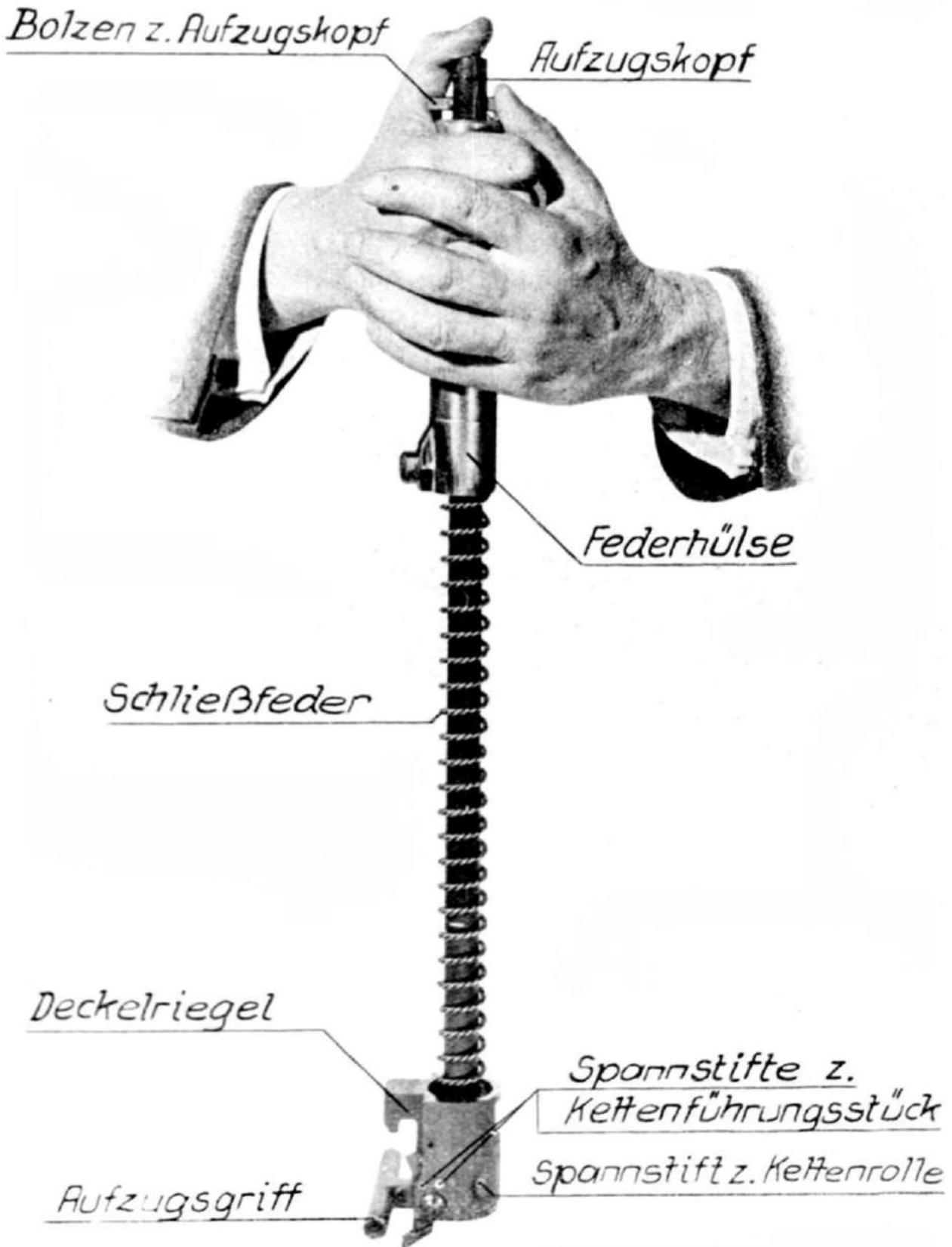
Abb. 71: Herausnehmen der Federhülse und der Schließfeder
