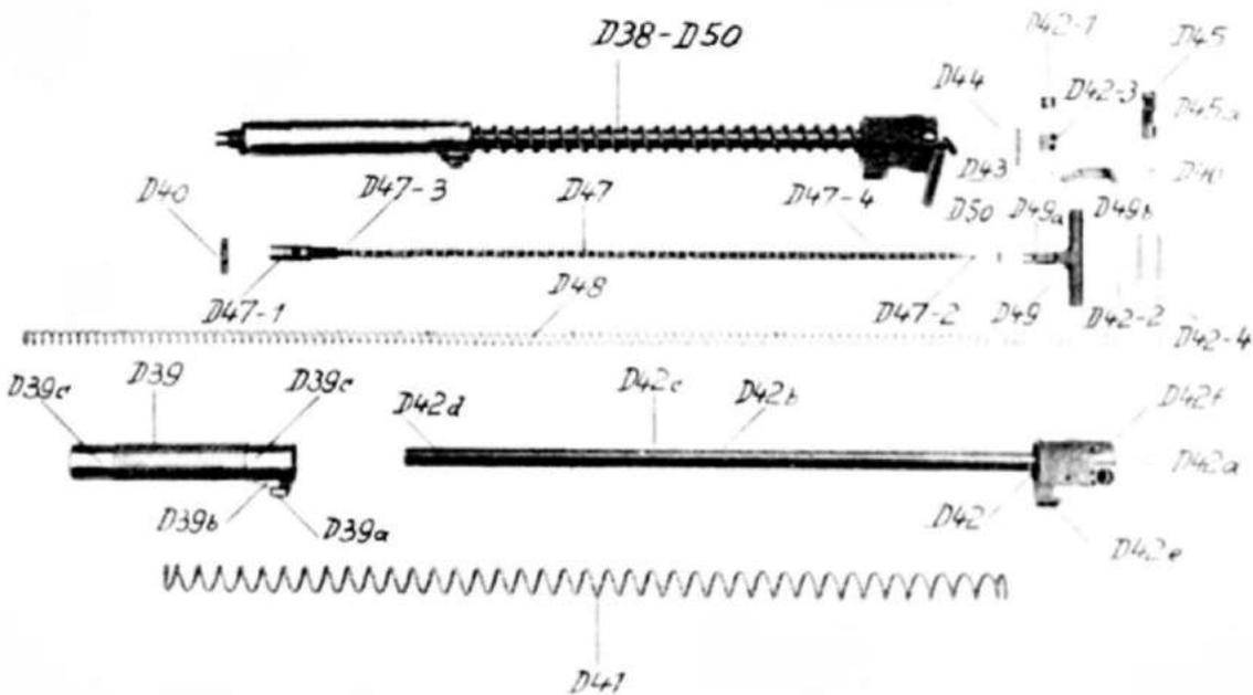
Abb. 25: Aufzug und Einzelteile
