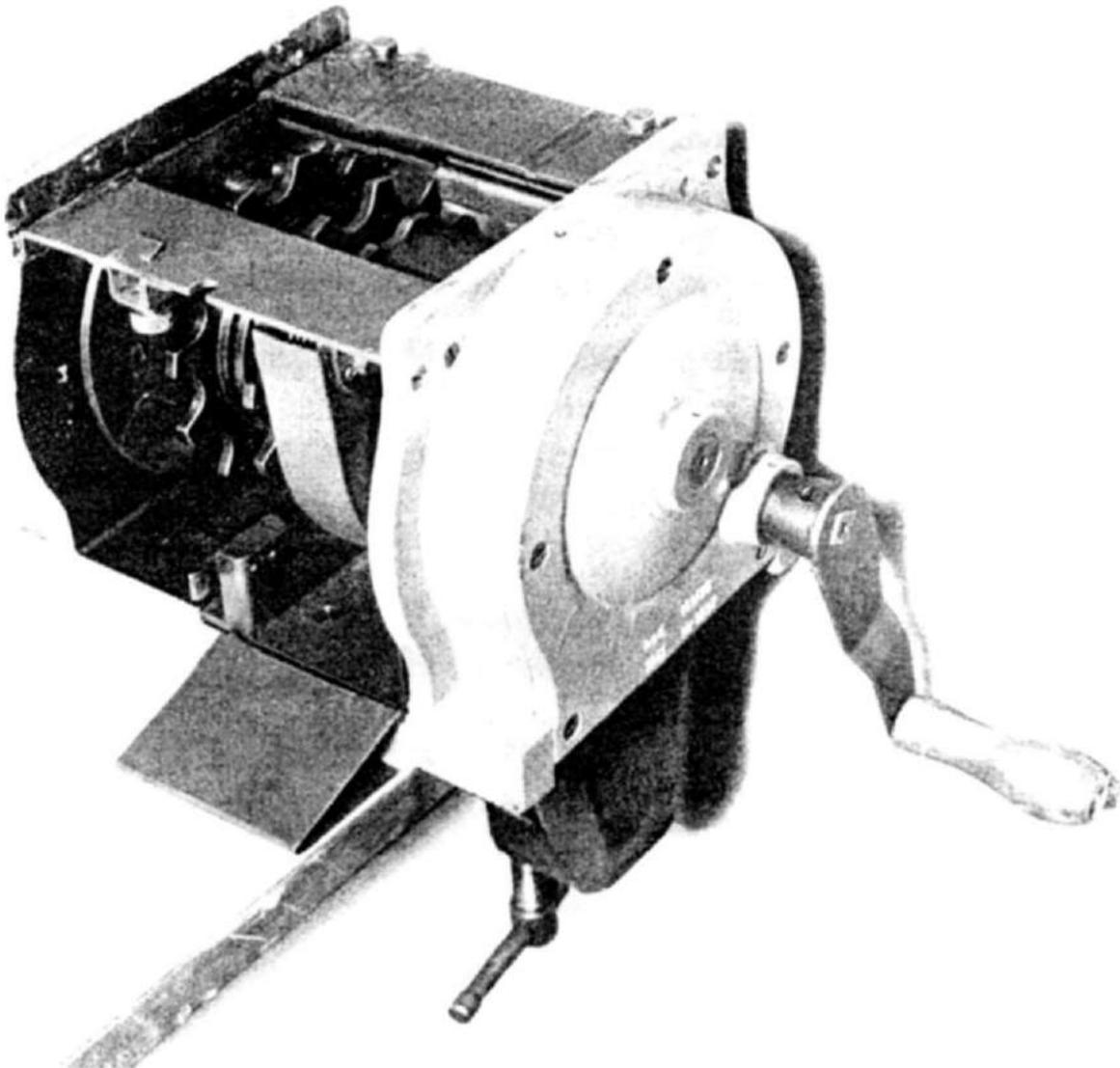
**Abb. 112: Gurtfüller 151; Gehäuse mit Getriebe, von links gesehen**
