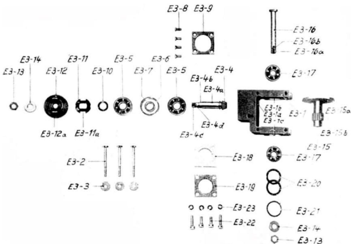
**Abb. 31: ED 151 B; Zahnradgetriebe; Einzelteile**
