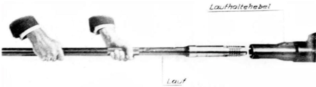
Abb. 52: Einsetzen des Laufes
