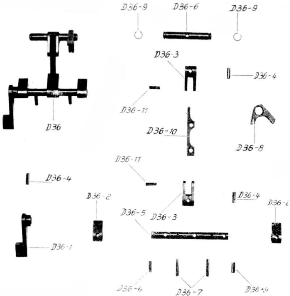
**Abb. 23: Auslöser und Einzelteile**
