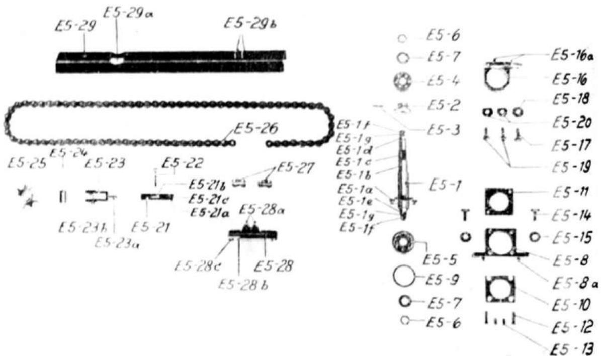
Abb. 33: ED 151 B; Kettentrieb; Einzelteile
