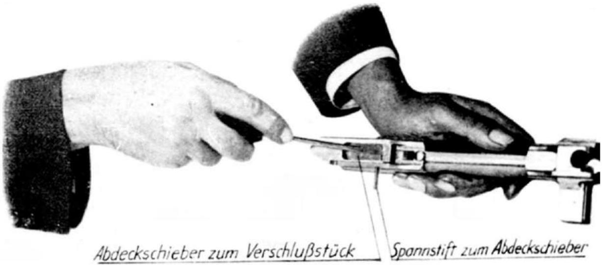
Abb. 81: Herausschieben des Abdeckschiebers zum Verschlußstück
