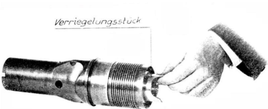
**Abb. 60: Herausnehmen des Verriegelungsstückes**
