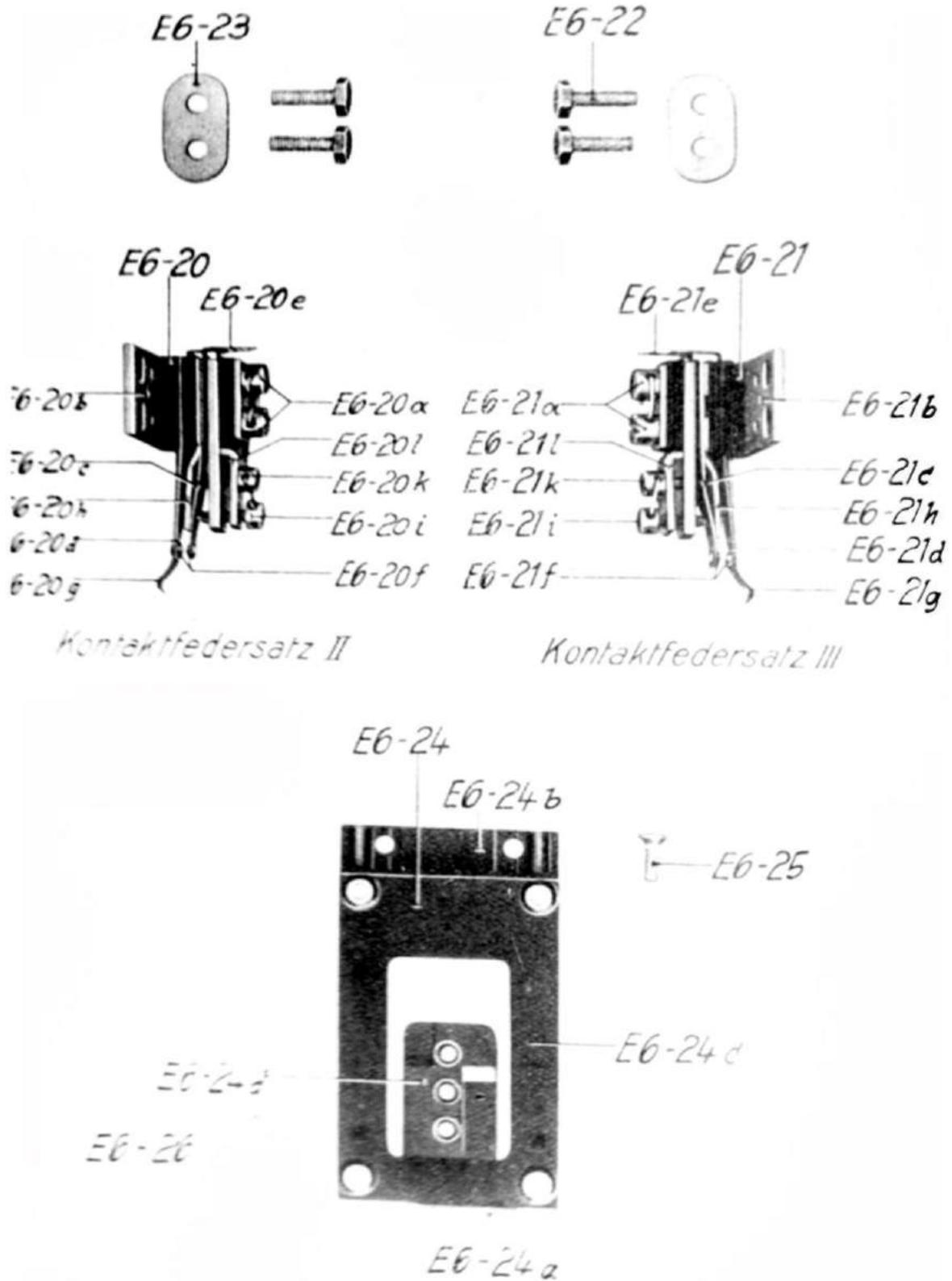
Abb. 35: ED 151 B; Kontakteinrichtung; Einzelteile. Kontaktfedersätze II und III mit Zubehör
