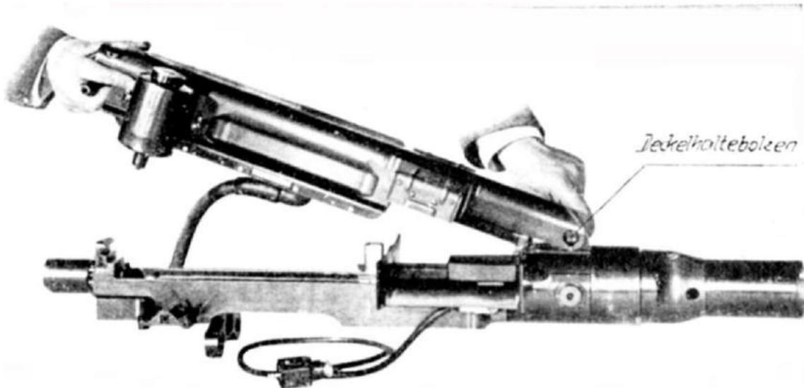
**Abb. 54: Herausziehen des Deckelhaltebolzens**
