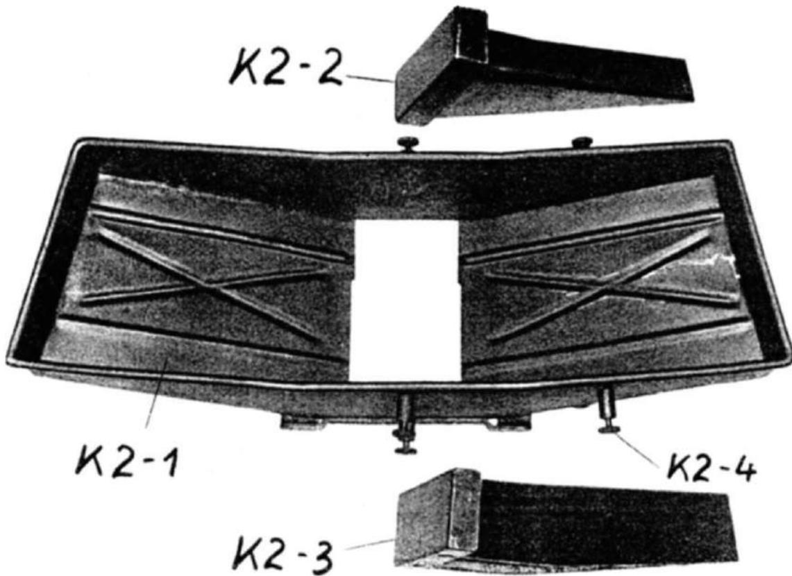
Abb. 113: Gurtfüller 151; Trichter, Einzelteile
