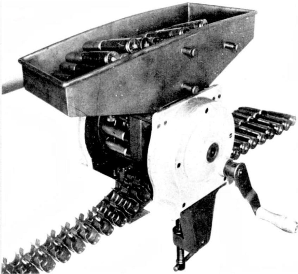
**Abb. 108: Gurtfüller 151 von Abb. 107 mit eingelegter Munition**
