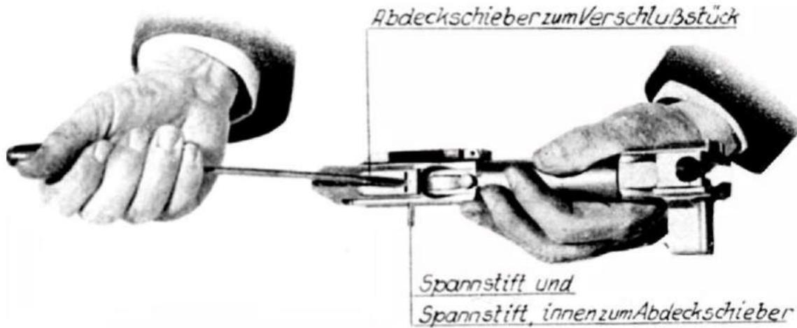
Abb. 86: Herausschieben des Abdeckschiebers zum Verschußstück (EZ)
