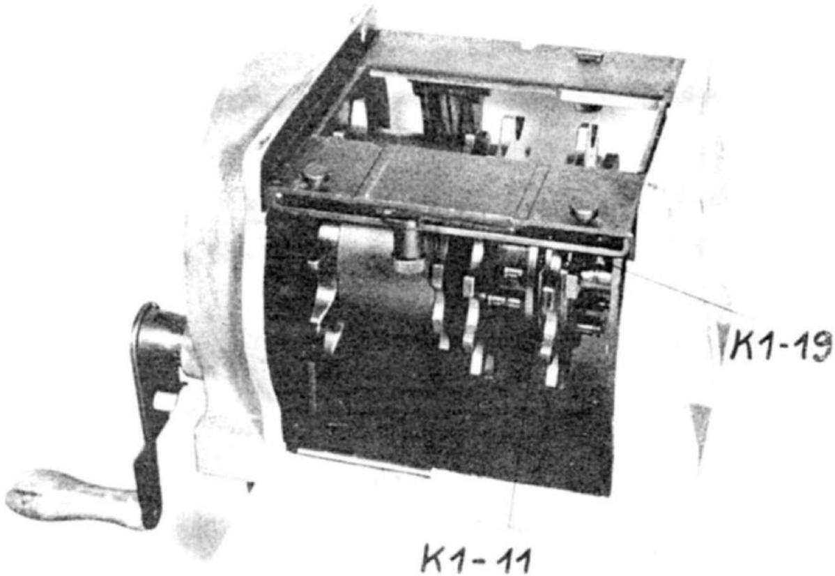
**Abb. 111: Gurtfüller 151; Gehäuse mit Getriebe, von rechts gesehen**
