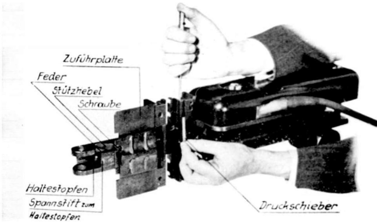
Abb. 75: Herausnehmen des Druckschiebers (Deckel nach rechts gekippt!)
