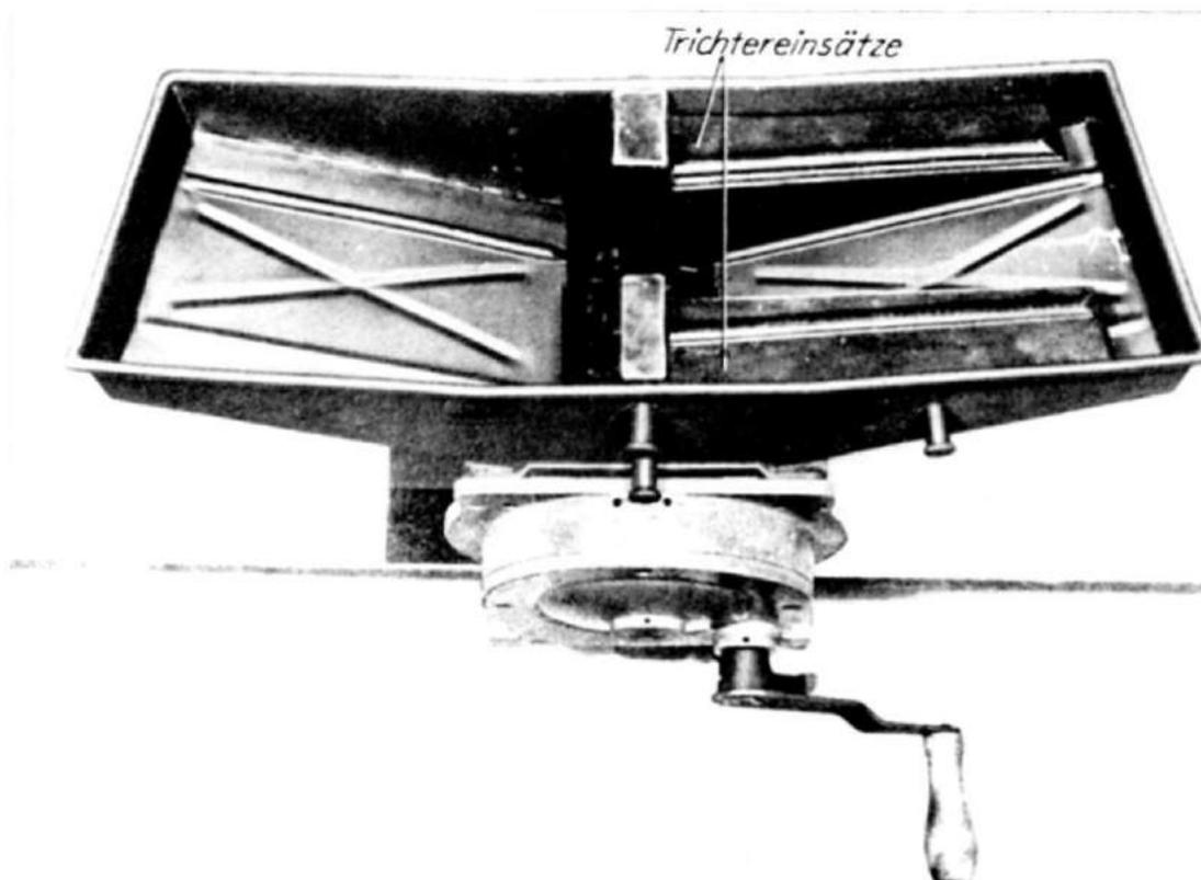
Abb. 105: Gurtfüller 151 mit Trichtereinsätzen zum Gemischtgurt
