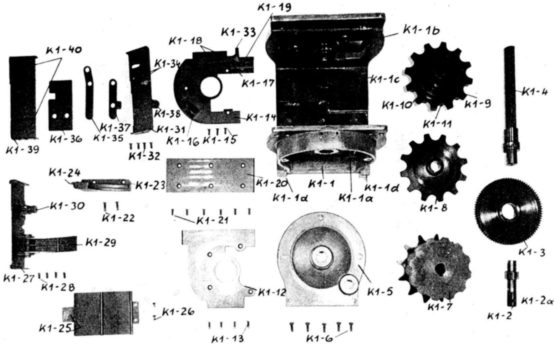
Abb. 110: Gurttüller 151; Gehäuse mit Getriebe, Einzelteile
