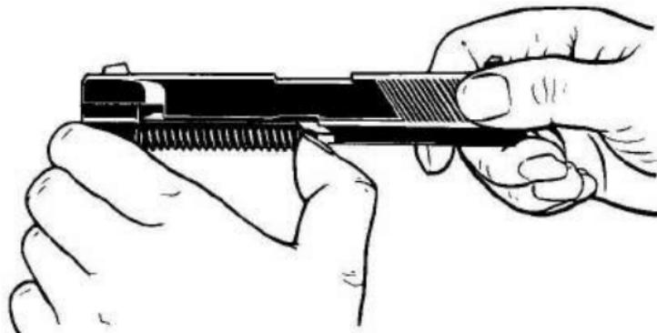
Schließfederrohr leicht nach vorn drücken und mit der Schließfeder herausheben. Danach kann auch das Rohr entnommen werden.
