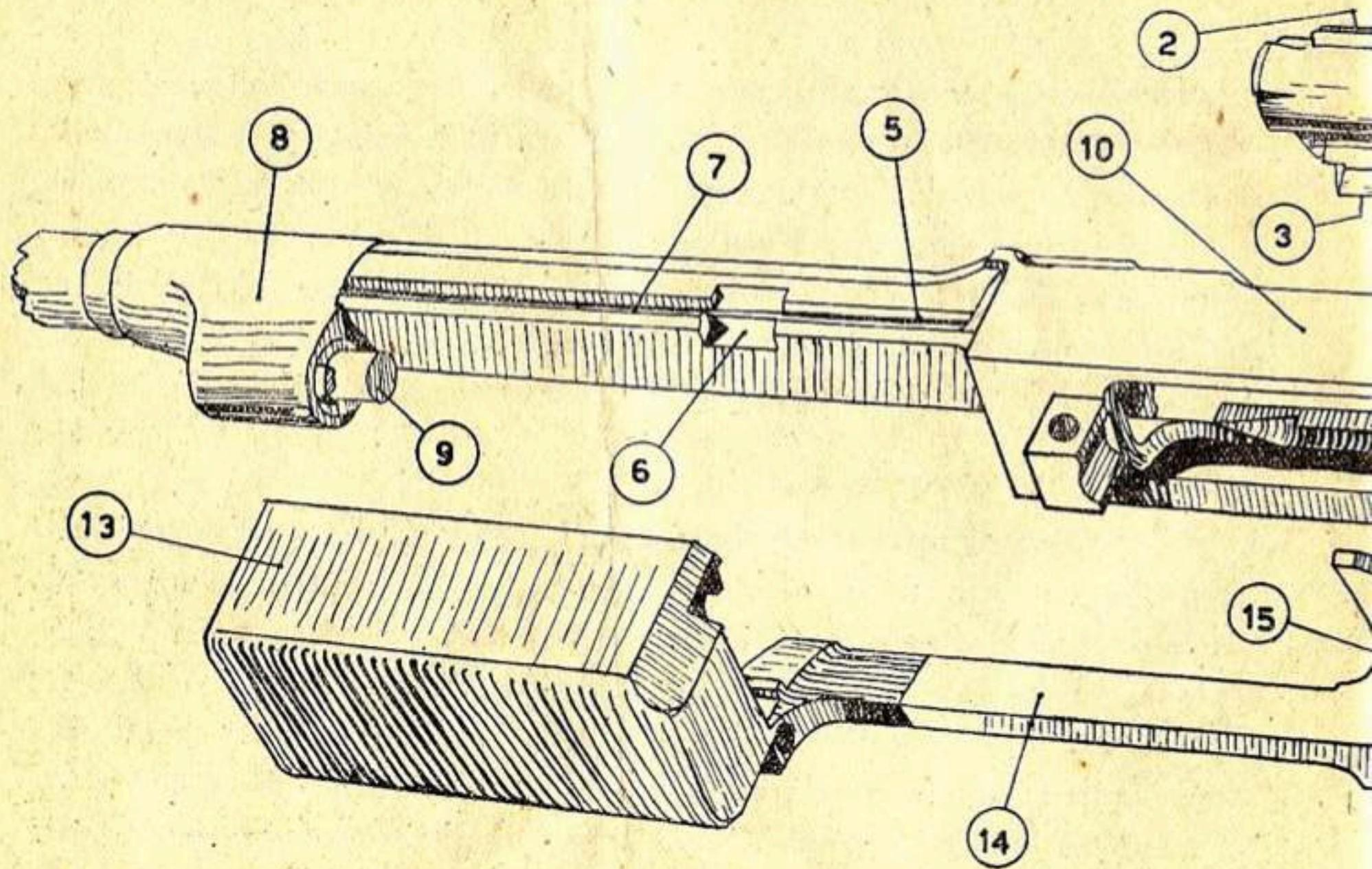
fig. 4 - otturatore, culatta, castello, carrello
